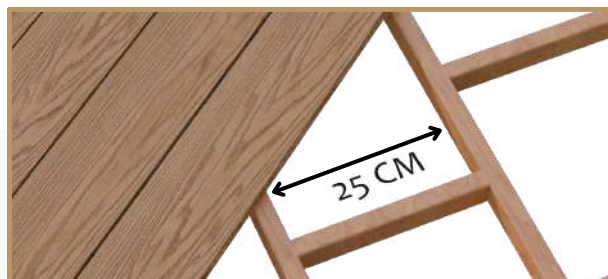
INSTALLATION EN DIAGONALE
